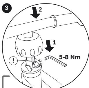
Inserire ad incastro il manubrio e avvitare la vite. Posizionare il taglietto del tubo dello sterzo verso dietro (!). Dopodiché spingere la calotta sferica con determinazione verso il basso fino a farla incassare.
