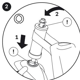
Надеть рулевой стержень через головную трубу, до упора. Соблюдать правильное расположение подшипника рулевого вала (!). Вставить подкладную шайбу. Повернуть носики рулевой трубы назад (!).
