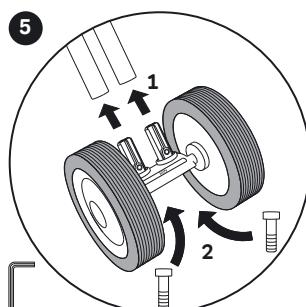
Enficher l'essieu arrière dans le cadre dans la position souhaitée - hauteur d'assise min. (27 cm) ou hauteur d'assise max. (29 cm). Insérer les vis et les serrer avec l'outil (clé Allen).
