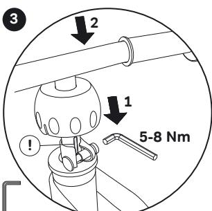
Kierownicę wsunąć do oporu na rurę sterową widełka i przykręcić śrubę. Szczelinę w kierownicy skierować do tyłu (!). Kulistą osłonę wcisnąć mocno w dół do zatrzaśnięcia.
