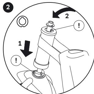
Inserire la forcella attraverso il tubo dello sterzo fino all'incastro. Verificare la direzione corretta del cuscinetto dello sterzo (!). Inserire la rondella. Orientare le alette sul tubo della forcella verso la parte posteriore (!).
