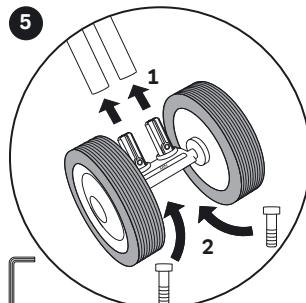
Achteras in de gewenste oriëntatie - minimale zithoogte (27 cm) of maximale zithoogte (29 cm) - in het frame steken. Schroeven plaatsen en met gereedschap (inbus) vastschroeven.
