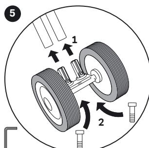
Oś tylną w żądanym ustawieniu – wysokość siedzenia min. (27 cm) lub wysokość siedzenia maks. (29 cm) – włożyć w ramę. Śruby osadź i przykręcić narzędziem (kluczem imbusowym).
