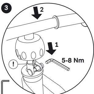
Deslizar el manillar hasta el tope sobre el tubo de la horquilla y apretar el tornillo. Orientar la ranura en el manillar hacia atrás (!). Presionar a continuación la cubierta esférica firmemente hacia abajo hasta que encaje.
