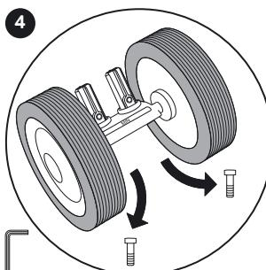
Desenrosque los tornillos del eje trasero.
