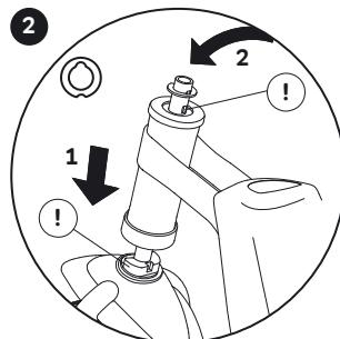
Gabelschaft durch das Steuerkopfrohr,
