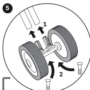
Zadní nápravu vložte do rámu v požadované orientaci - min. výška sedla (27 cm) nebo výška sedla max. (29 cm). Nasadte šrouby a utáhněte je pomocí nástroje (vnitřní šestíhran).
