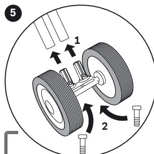
Insertar el eje trasero en el bastidor en la dirección deseada -altura mín. del asiento (27 cm) o altura máx. del asiento (29 cm). Colocar los tornillos y apretar con la herramienta (llave Allen).
