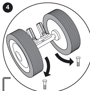
Schrauben aus Hinterachse herausdrehen.
