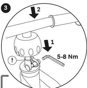
Placer le guidon sur la potence jusqu'à la butée et serrer la vis. Orienter la fente dans le guidon vers l'arrière (!). Enfoncer fermement le cache sphérique vers le bas jusqu'à ce qu'il s'encliquète.
