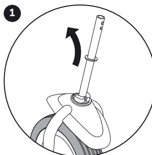
Удалить защитную систему транспортировки
