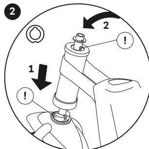
Insérer la potence dans le tube de la tête de commande jusqu'à la butée. Veiller au positionnement correct du roulement de direction (!). Installer la rondelle. Orienter vers l'arrière le nez de la tige de fourche (!).
