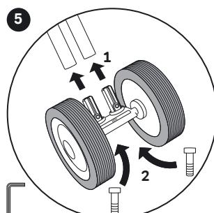
Inserire l'asse posteriore nel telaio (altezza minima (27 cm) o massima del sedile (29 cm) nell'orientamento desiderato. Inserire le viti e serrarle con l'utensile (chiave a brugola).
