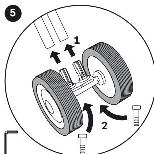
Вставить в раму заднюю ось в желаемом положении – высота сиденья мин. (27 см) или высота сиденья макс. (29 см). Вставить болты и затянуть с помощью инструмента (имбусового ключа).
