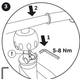
Вставить руль в рулевой стержень до упора и прочно закрутить винт. Отверстие в руле должно быть ориентировано назад (!). Надавить на чашку вниз до защелкивания.
