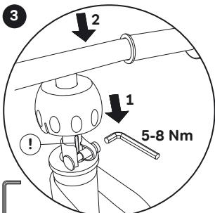
Het stuur tot aan de aanslag op de vorkbuis schuiven en schroeven vastdraaien. Sleuf in de stuurpen naar achteren richten (!). Kogelkap vervolgens stevig omlaag drukken totdat deze vastklikt.
